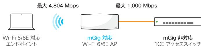
Wi-Fi 6/6E のポテンシャルを最大化：マルチギガビット (mGig) 対応アクセススイッチ
