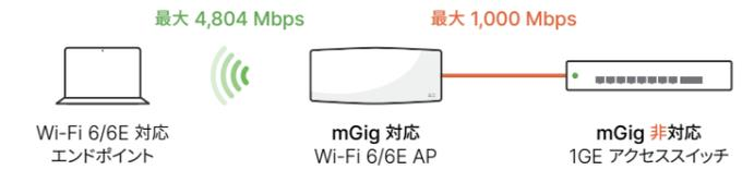
Wi-Fi 6/6E のポテンシャルを最大化：マルチギガビット (mGig) 対応アクセススイッチ
