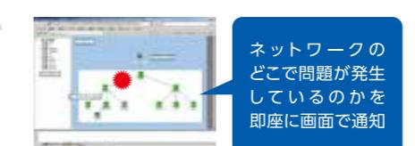
SNMP (Simple Network Management Protocol) を用いた監視によってネットワーク機器の稼動状況を常に収集・検知することができ、故障やネットワーク断などの障害時には速やかに警告を発します。また、アラーム出力リレーとPLCを連携させることでSCADAへの通知も可能です。これらにより、万が一の際の迅速な対処、ダウンタイムの低減が可能です。
